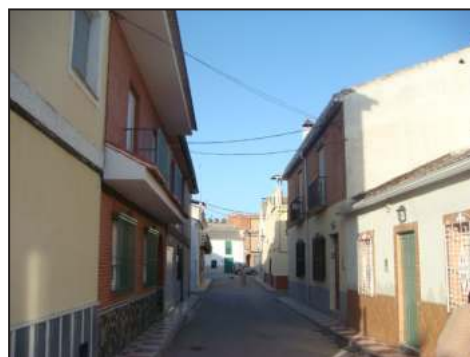
El entramado urbano de trazado ortogonal plantea menos problemas de integración paisajística para redes aéreas que mantienen dicha ortogonalidad (izq.), que para redes que contienen elementos de ruptura de la misma, como son los cruces en oblicuo (dch.).
